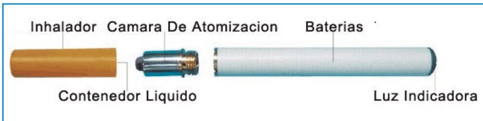
**Figura 1.** Partes de un cigarrillo electrónico.
