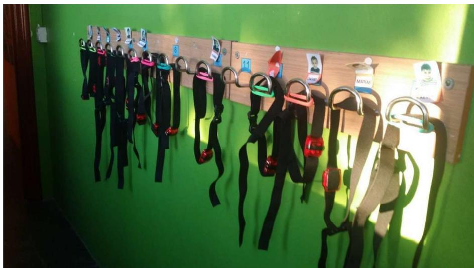
*Figura 4.* Acelerómetros utilizados para medir los niveles de actividad física de los escolares. Cada día se dejaban preparados en las perchas de los estudiantes, quienes se los ponían antes de empezar las clases.
